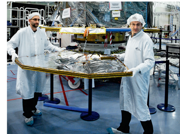
Assemblage des panneaux solaires de Gaia en salle blanche à Toulouse mi-2013.
